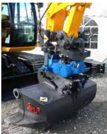
Łyżka skarpowa SMP zainstalowana z wykorzystaniem technologii SMP Swingtilt®
